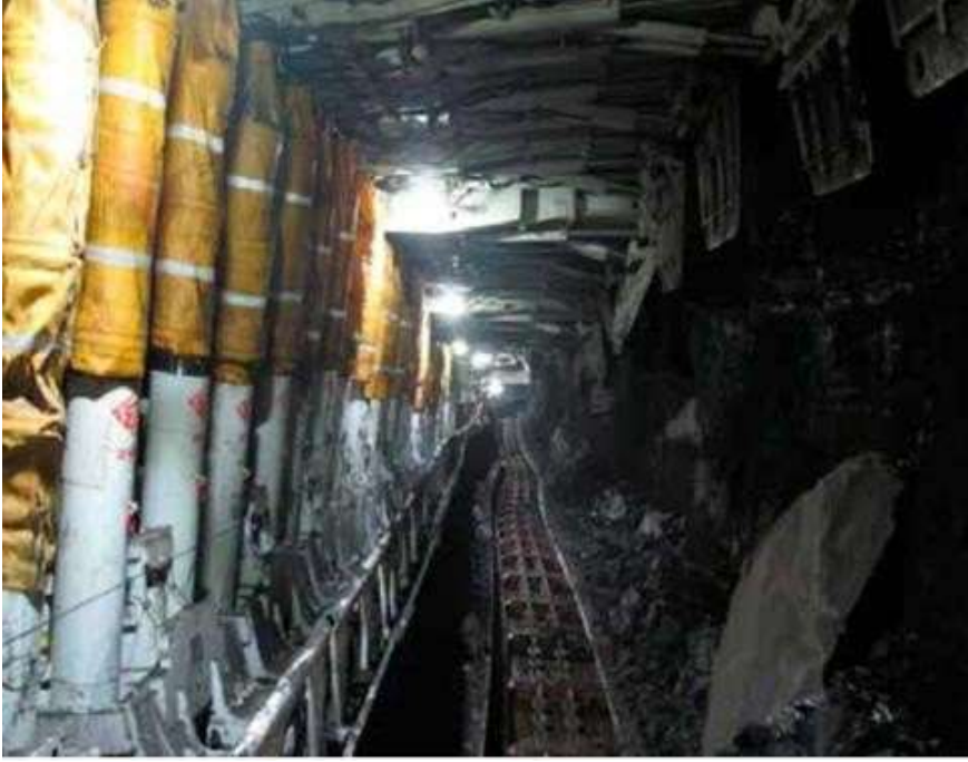
Şekil 6. Tam mekanize bir uzunayaktan görünüm (Yetkin, 2013)
