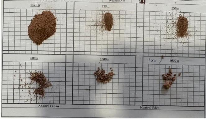
Şekil 4. Numunenin asitle muamele sonrasında kalan kısmı
