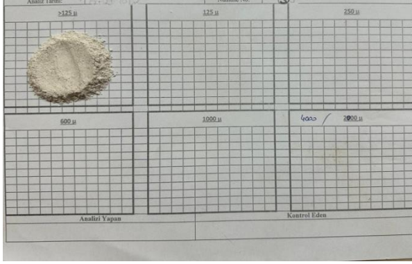
Şekil 3. Numunenin asitle muamele sonrasında kalan kısmı
