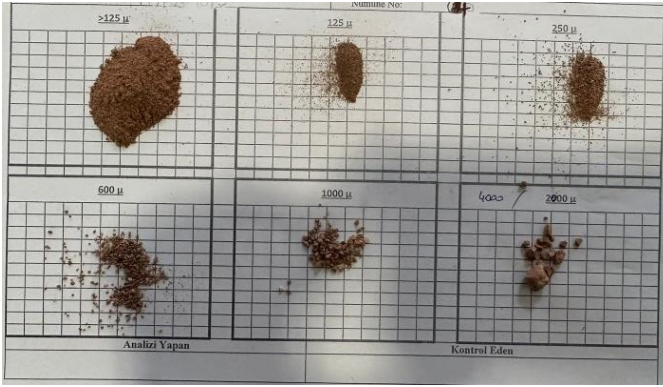
Şekil 4. Numunenin asitle muamele sonrasında kalan kısmı
